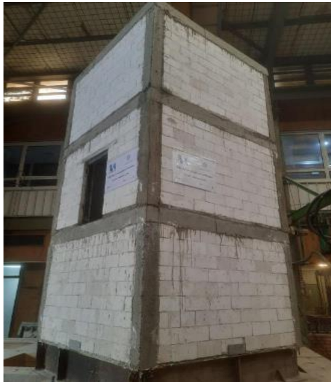
شکل ۱- نمونه آزمایشگاهی با دیوار باربر AAC
