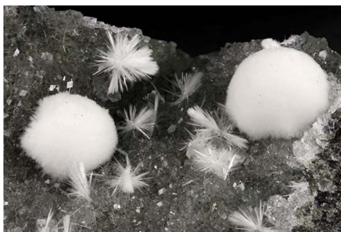
شکل ۷-۱- ساختار بلوری توبرموریت و زونولیت
