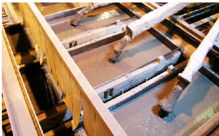
شکل ۱-۲- ریختن دوغاب به درون قالب‌ها
