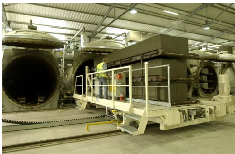
شکل ۱-۶- بلوک‌های خام به درون اتوکلاو تغذیه می‌شوند
